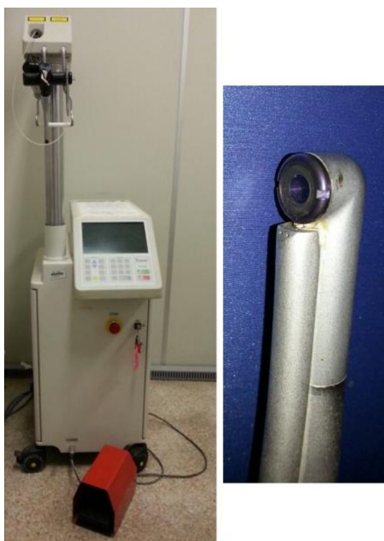
Figura 19 - Sistema laser Er:YAG (à esquerda) e detalhe da saída de luz da peça de mão (à direita).
